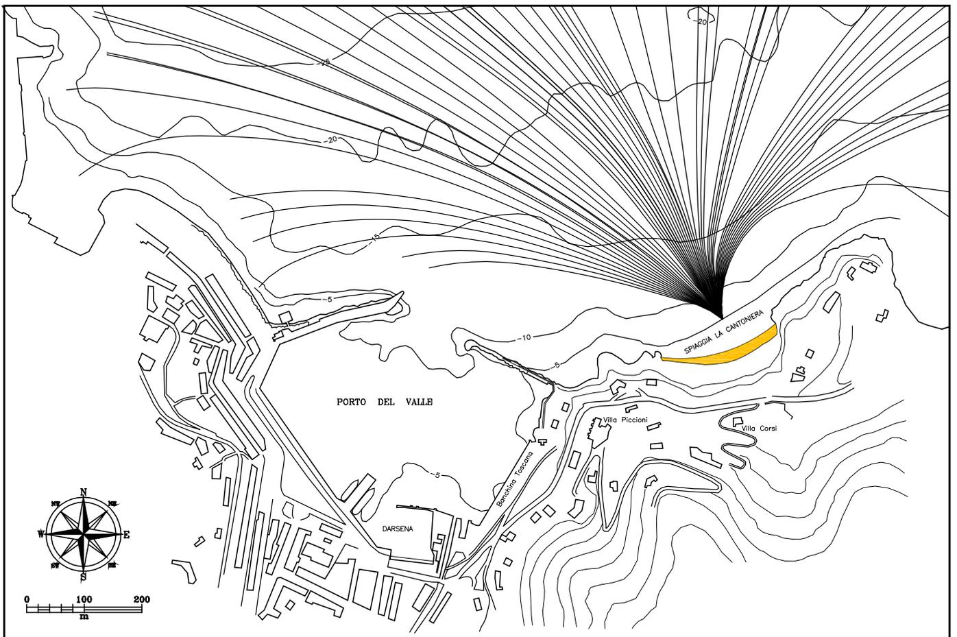
Fig.8 : Esempio di piano d'onda inverso relativo al periodo  $T = 9$  s - SITUAZIONE ATTUALE
